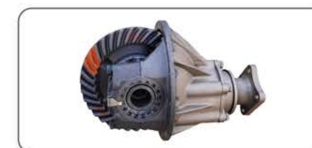
Đùm Cầu Com Lê Reducer Assembly
